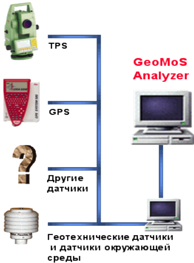
Рисунок 7.35 – Принцип сбора данных системы GeoMoS
