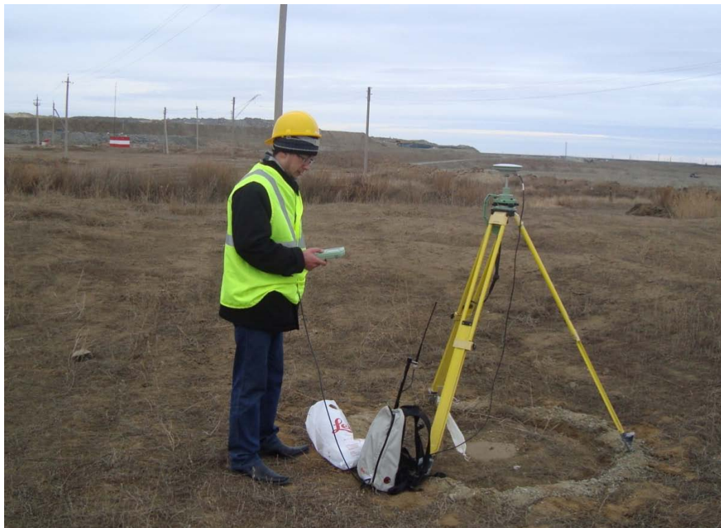
Рисунок 7.43 – Наблюдение за сдвижением карьерных откосов с помощью GPS
