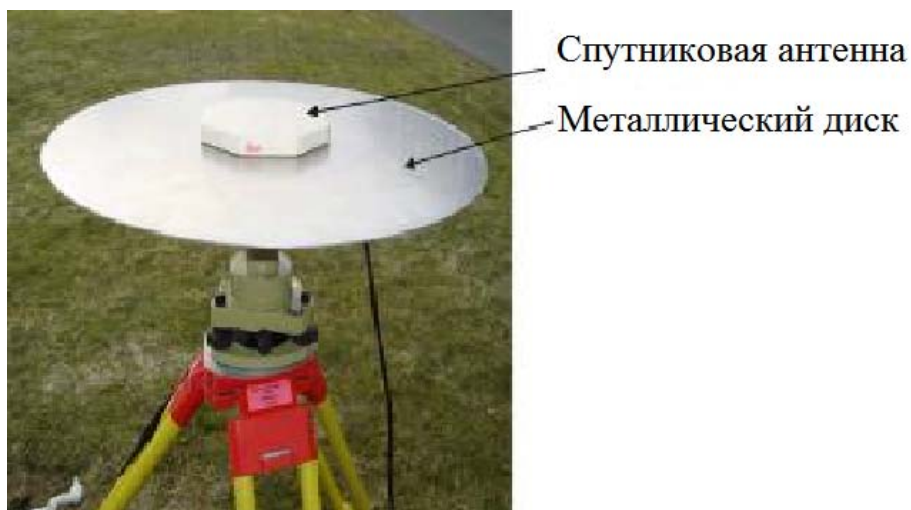
Рисунок 7.13 – Антенна с металлическим диском для отсекаания отраженных сигналов
