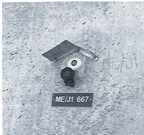
Obr.3 Optický terč a odrazný hranol v betonové hrázi přehrady
