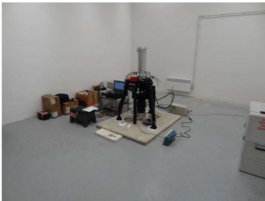
Obr. 3 – testovací měření tíhového zrychlení na absolutním bodě Brno-VUT
