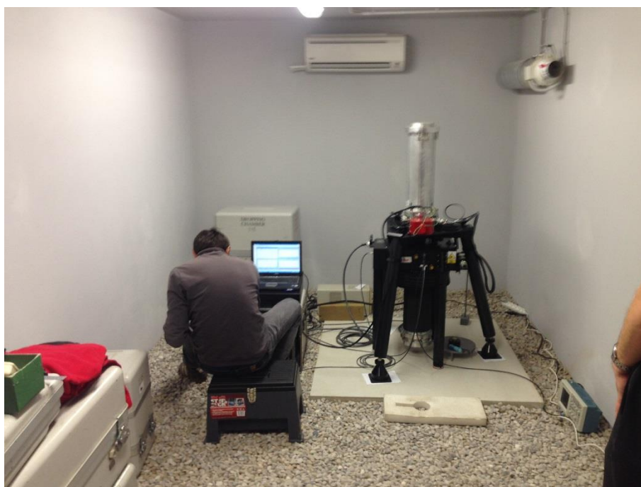
Obr. 2 – testov c  m řen  t hového zrychlen  na absolutn m bod  Plzeň-NTIS
