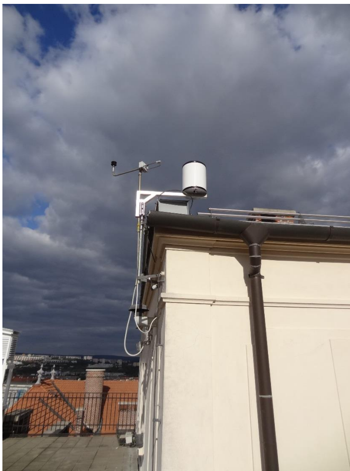
Obr. 5 – instalace srážkoměru na střeše budovy B poblíž stanice TUBO
