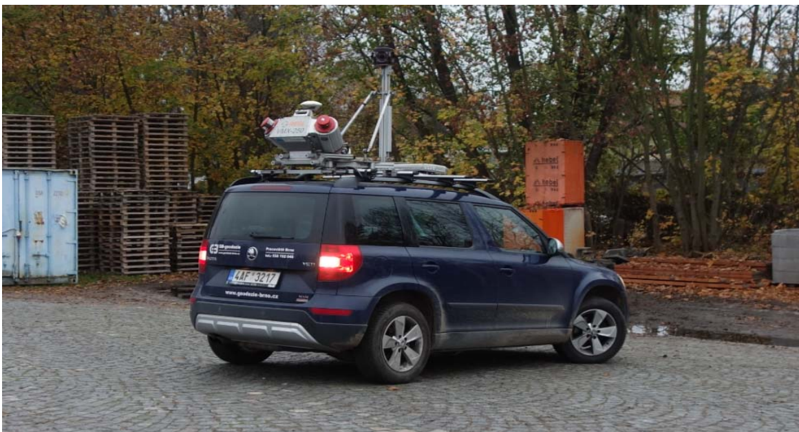
Obrázek 2-2 Aparatura mobilního laserového skenování firmy GB-geodezie, spol. s r.o.
