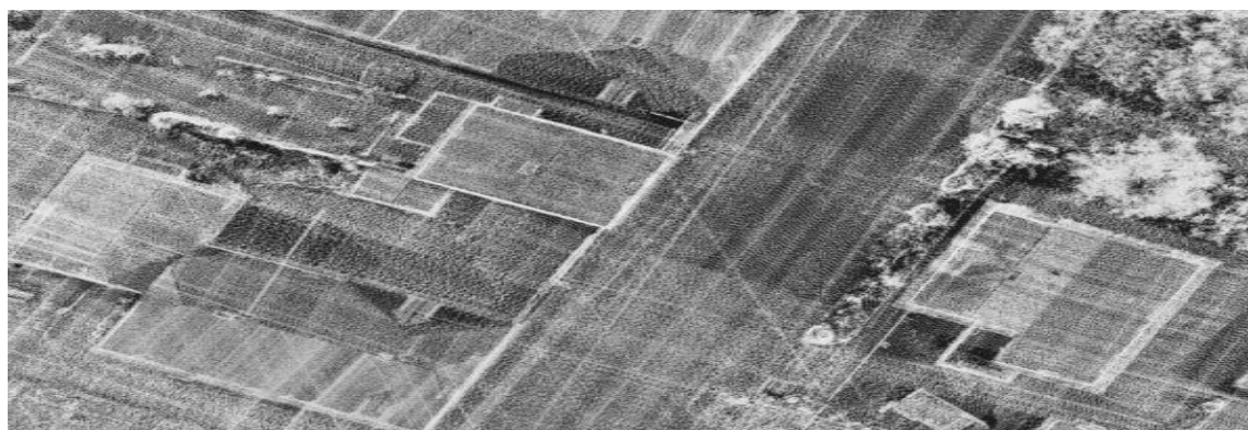
Obrázek 2-5 Ukázky hustého mračna bodů ze skenování dronem k.ú. Dlouhá Lhota
